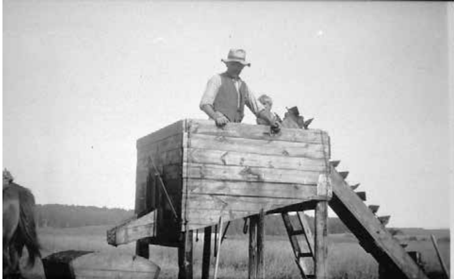
Æltemaskine drevet af hestemølle hos Peter Jørgensen, Damvejen 4, V. Strødam. Æltningen sker på tørvegravens kant og ses ikke på billedet, men sneglen som skruer den flydende tørvemasse op i "kassen", hvorfra den tømme ud i vognen foran og køres til tørring.
